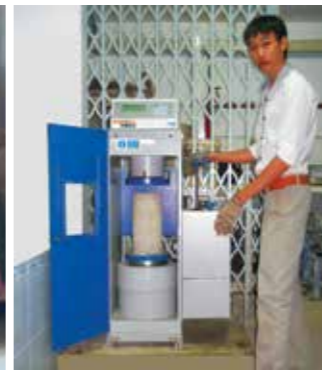
Thí nghiệm nén vữa và bê tông xi măng
