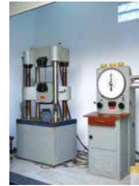
Thí nghiệm kéo thép và cáp dự ứng lực
