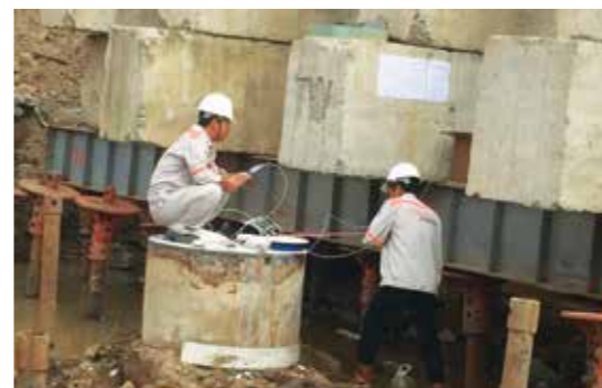
Thí nghiệm đo ứng suất và biến dạng co giãn trong thân cọc
