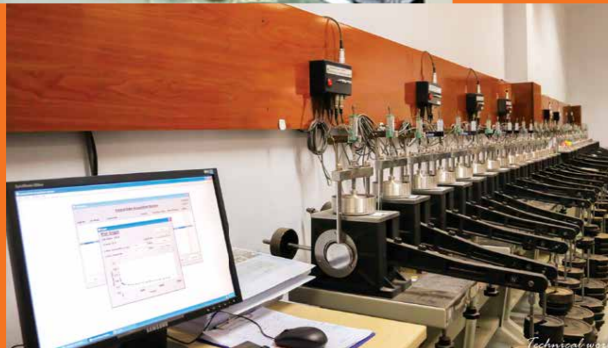
Kết nối hệ thống CDAS với thí nghiệm nén cố kết
