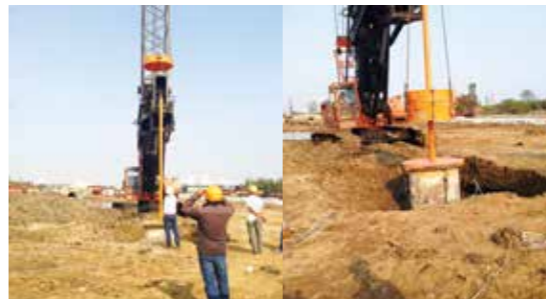
Thí nghiệm biến dạng lớn (PDA)
