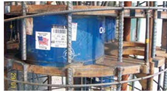
Thí nghiệm xác định sức chịu tải của cọc bằng phương pháp hộp tải trọng Osterberg (O-Cell)
